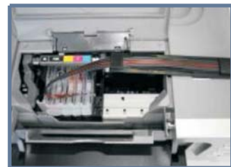
Tubo bien instalado
