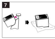
7. Retire el cartucho del adaptador y limpie con cuidado el exceso de tinta de los inyectores, apoyando el cabezal de impresión sobre unos pañuelos de papel. Instale el cartucho en la impresora, y ejecute la opción "limpieza de cabezales" antes de usarlo.
