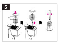
Retire la aguja unos 5mm hacia arriba e inyecte lentamente 10ml de tinta presionando el émbolo de la botella durante 15 segundos. Una vez hecho, retire la botella y la aguja del cartucho.
