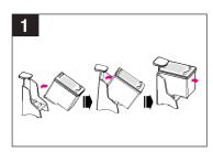
Coloque el cartucho en el soporte empezando por la parte de los inyectores, y empuje hacia abajo el cartucho, hasta que oiga un click.
