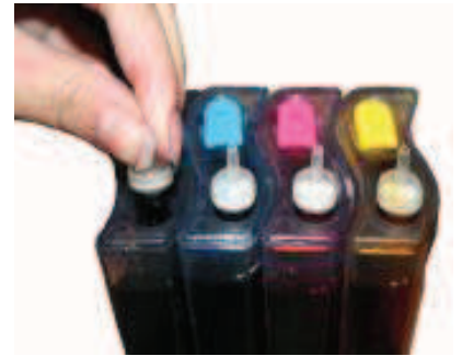
AL EXTRAER AIRE LA TINTA LLEGARA AL CARTUCHO
